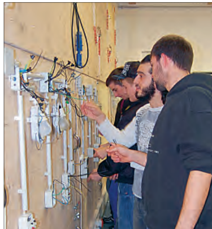
Diese Teilnehmer des Berufsgrundbildungsjahres Elektro lernen, was eine Wechselschaltung ist.
